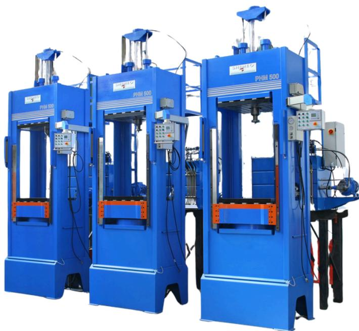
**Prensa Hidráulica de Bastidor** de 500 Toneladas diseñada para trabajos de ensamblado, enderezado, vulcanizado, estampado y prensado de componentes.
