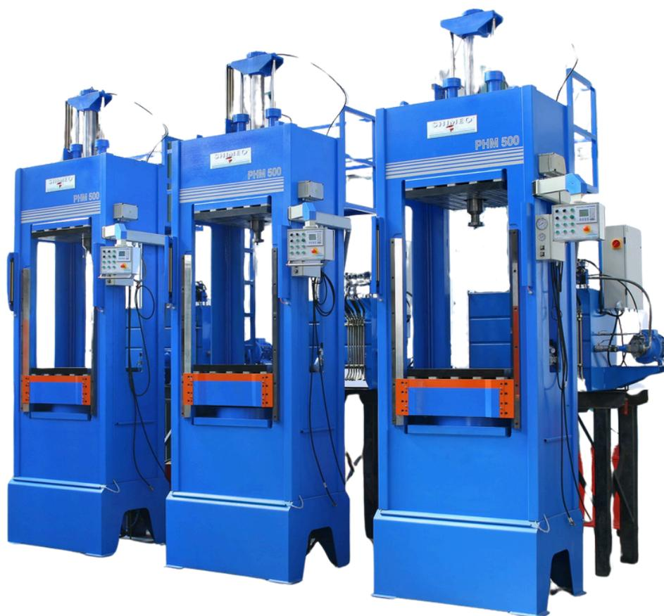
Las **Prensas Hidráulicas** de **Bastidor** están diseñadas para aplicaciones que requieren fuerza controlada, precisión de movimiento y adaptabilidad en diversos procesos industriales.
